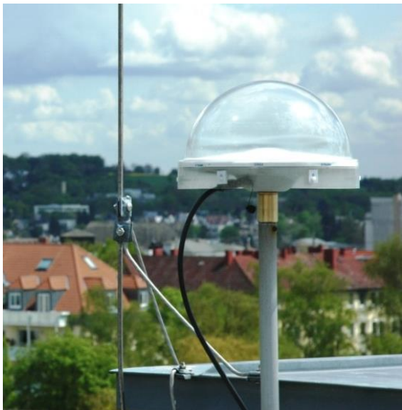
Abb. 3: Trimble Zephyr Geodetic 2 GNSS-Antenne auf der SAPOS®-Referenzstation Wiesbaden (S)
